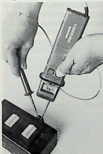
Bild 1: Digitaler Spannungsprüfer D422 mit intelligentem Innenleben (Siemens-Pressebild)
